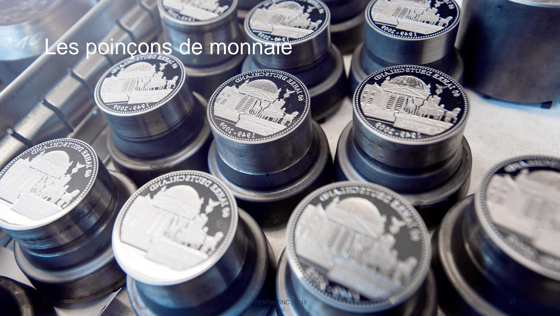
La qualité et la capacité de la technologie PECM à reproduire des détails très fins, la prédestine tout naturellement à la fabrication des poinçons de monnaie. Les centres d'usinage PEMTec réalisent des contours d'une précision exceptionnelle et d'excellents états de surface.
