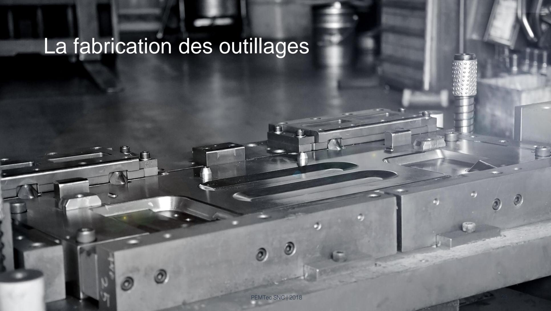
Avec la technologie PECM, réalisez des outillages innovants et à durée de vie accrue. Les outils de découpe, de frappe ou encore de roulage obtenus aujourd'hui avec les centres d'usinage PEMTec sont des gages de fiabilité et d'efficacité pour les productions en série.
