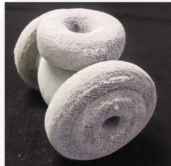
Moule de fonderie en alumine réalisé
