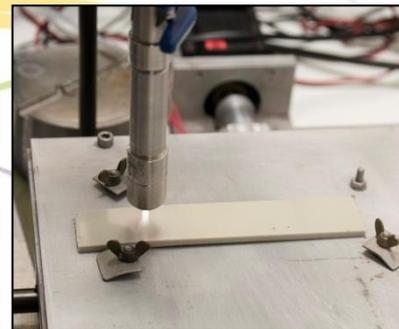
Une mise en peinture est réalisée sur des échantillons traités et non traités par plasma.
