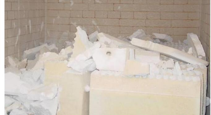
Explosion d'un bloc de béton
